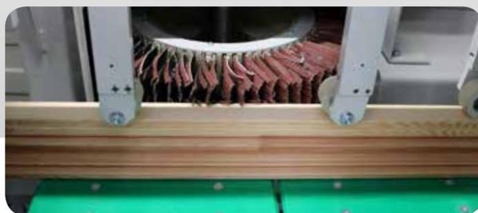
Posizionamento orizzontale automatico dei gruppi portaspazzole con corsa orizzontale di 300 mm. su guide lineari. Posizionamento orizzontale e inclinazione gestiti in automatico dal controllo elettronico.
