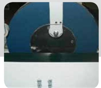
Spazzola cilindrica Ø 420 mm h 120 mm motore da 1,1 kW con possibilità di inclinazione a tre stadi +35°- 0°- -12° e scorrimento laterale con corsa da 150 mm.
